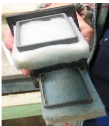
Kuva 36. Laitteisto D:n suodattimet olivat melkein puhtaat seuranta-ajan toukokuussa.
