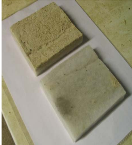
Kuva 35. Laitteisto C:n likainen suodatin verrattuna puhtaaseen suodattimeen seuranta-ajan toukokuussa 2007.
