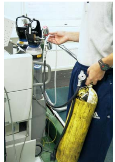
Kuva 1 Hengityskaasuanalysointilaitteisto kalibroitiin ennen testiä paineilmalaitteen ilmalla.
