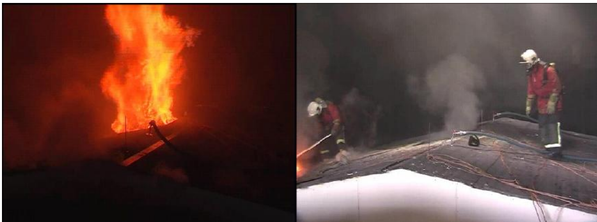
Kuvat 6a ja 6b. Vasemmalla savunpoistoluukku avattuna ennen pistosuihkuputkilla sammutusta ja oikealla pistosuihkuputkilla suoritetun sammutuksen jälkeen [2].
