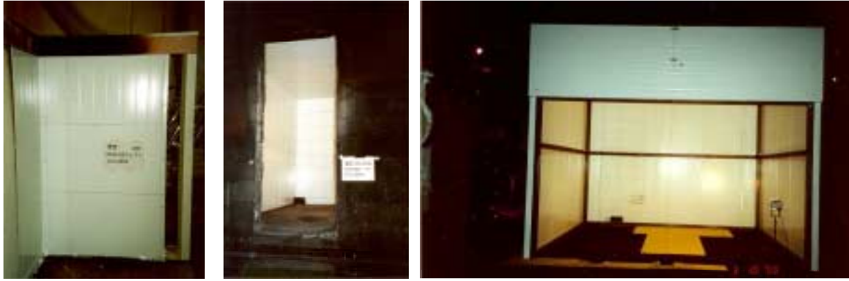
Kuva 1. Koekappaleita. Vasemmalla: SBI-testin koekappale. Keskellä: palokammiotestin koekappale palokammion oviaukosta katsottuna. Oikealla ISO 13784-2 -testin koekappale.
