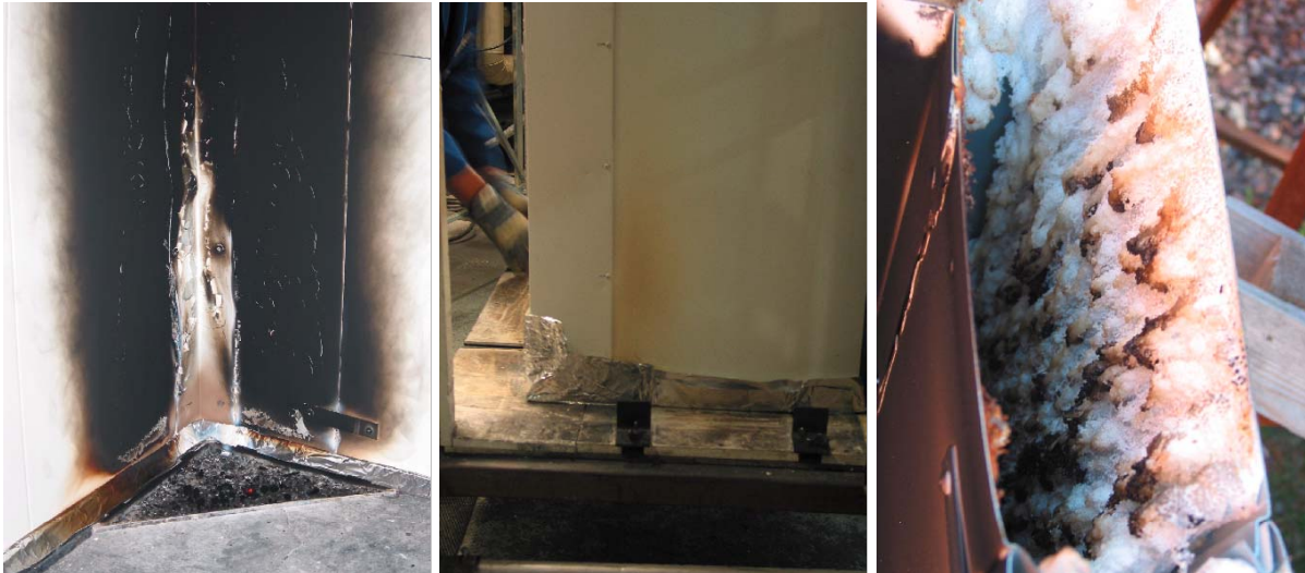
Kuva 4. Sandwich-elementti SBI-kokeen jälkeen. Vasemmalla: elementti edestä. Keskellä: elementti takaa, taustapelti on hieman tummunut. Oikealla: elementti ylhäältä, EPS-eriste on kutistunut ja sulanut.
