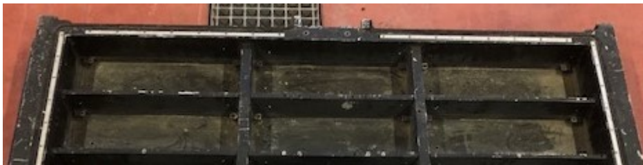
Bild 5. Batteripackets inre konstruktion i en Audi.
