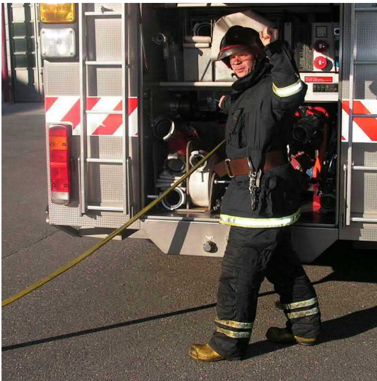
Konemies toistaa vesimerkin ja säättää tarvittavan pumppupaineen.
