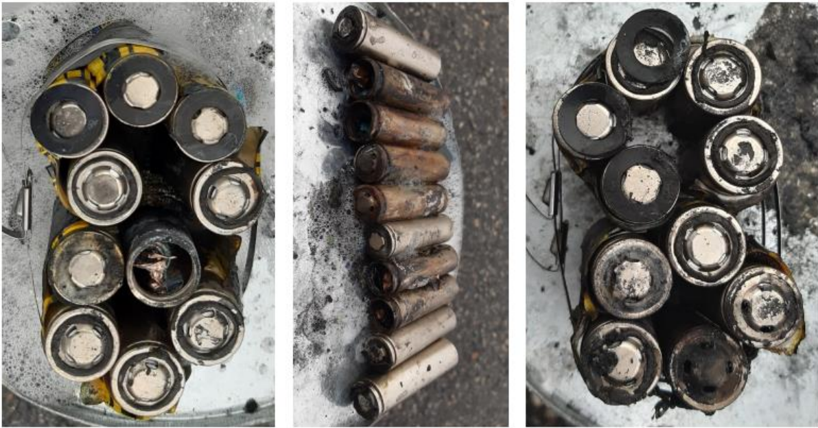
Kuva 10. Kennot Gloria -vaahtosammuttimella sammuttamisen jälkeen.
