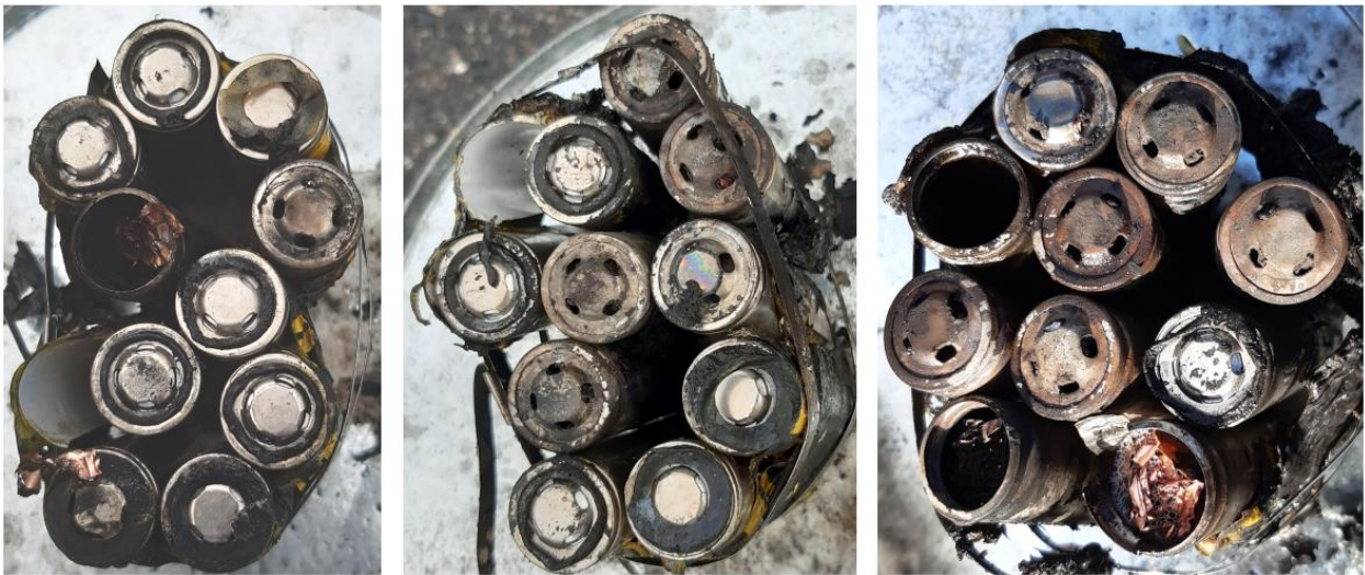
Kuva 8. Kennot Total WD 9 F-500-sammuttimella sammuttamisen jälkeen.
