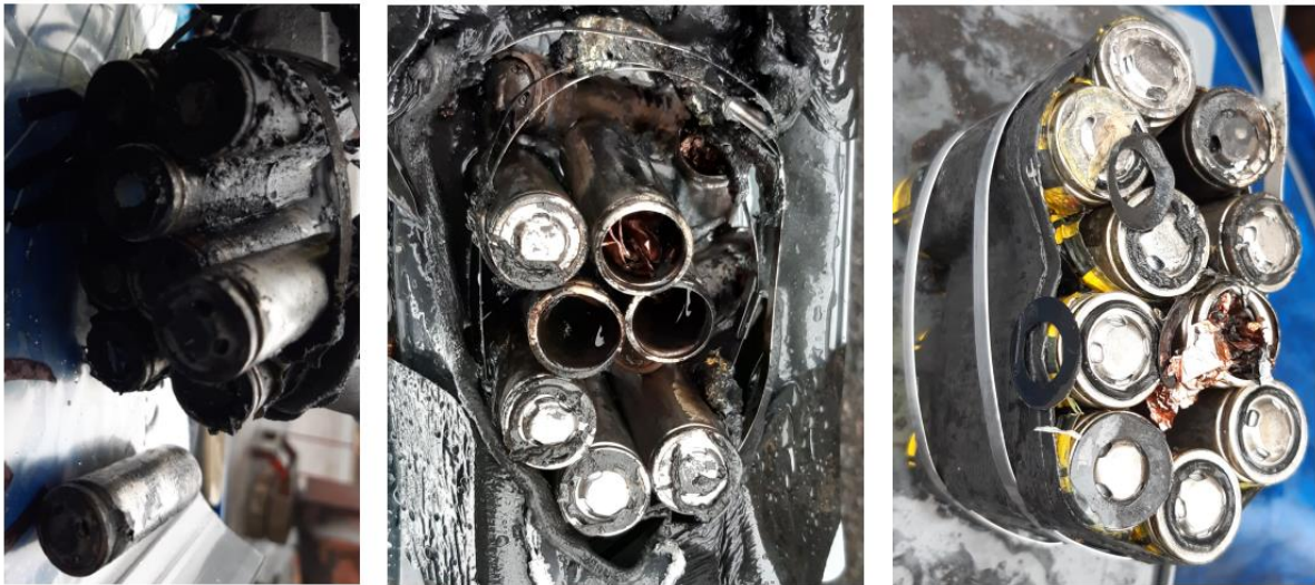
Kuva 6. Kennot vesisuihkusammutuksen jälkeen.
