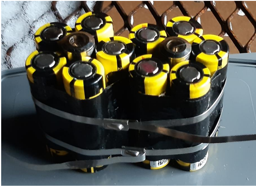
Kuva 2. Kennoja järjestettynä nippuun. Kuvassa näkyy myös juotoskynien päät.
