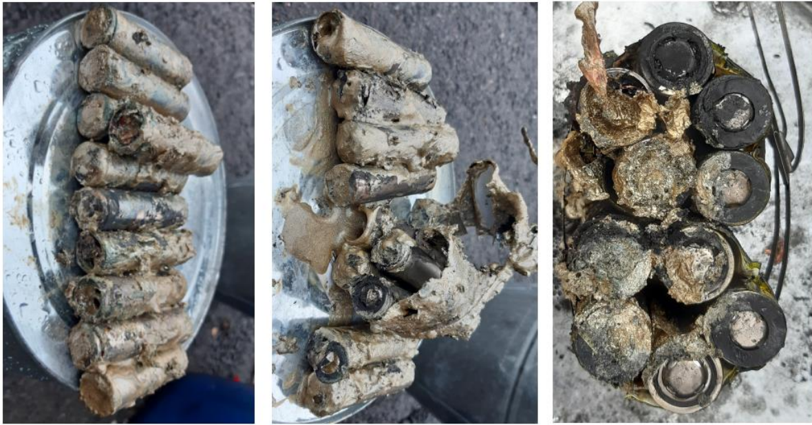
Kuva 9. Kennot Housegard AVD -sammuttimella sammuttamisen jälkeen.
