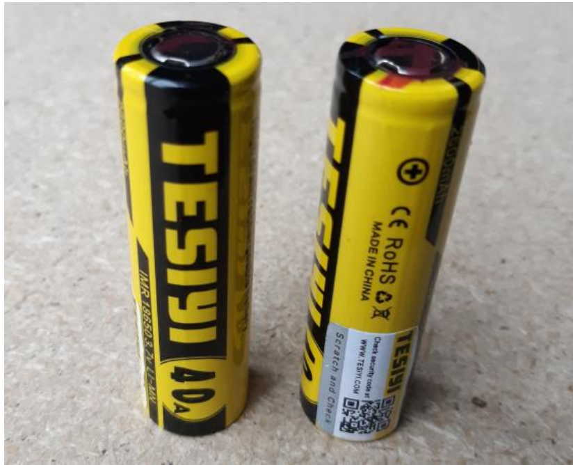
Kuva 1. Testeissä käytettyjä 18650 -kennoja.
