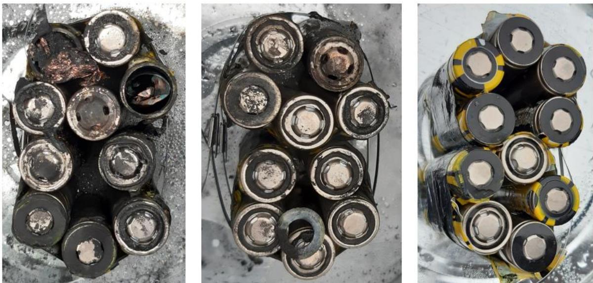
Kuva 7. Kennot Presto LB6 -sammuttimella sammuttamisen jälkeen.
