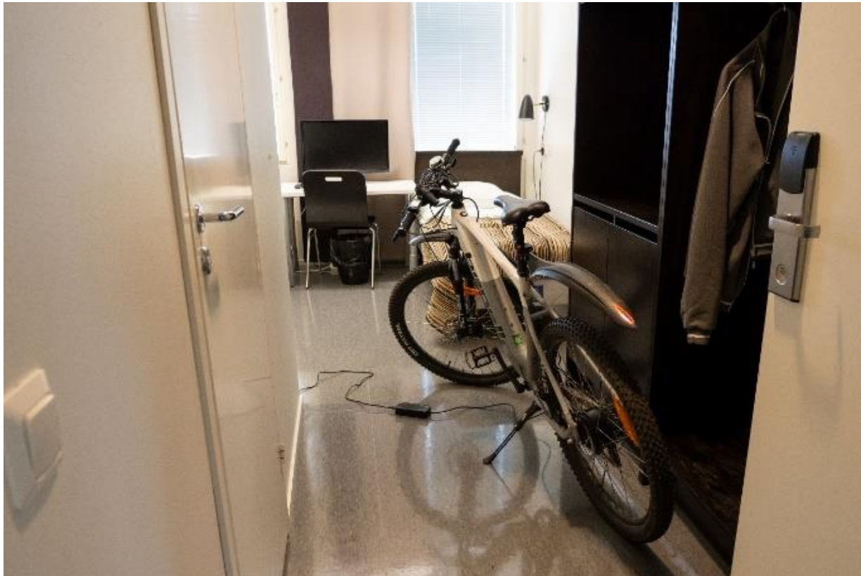
Kuva 2. Polkupyörä poistumisreitillä hotellihuoneessa. Akkupalotilanteessa savukaasut ja mahdolliset liekit estävät henkilön pääsyn pois huoneesta.
