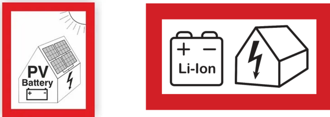
Kuva 1. Esimerkkikuvat aurinkosähkö- ja akkujärjestelmästä ilmoittavasta merkistä.
