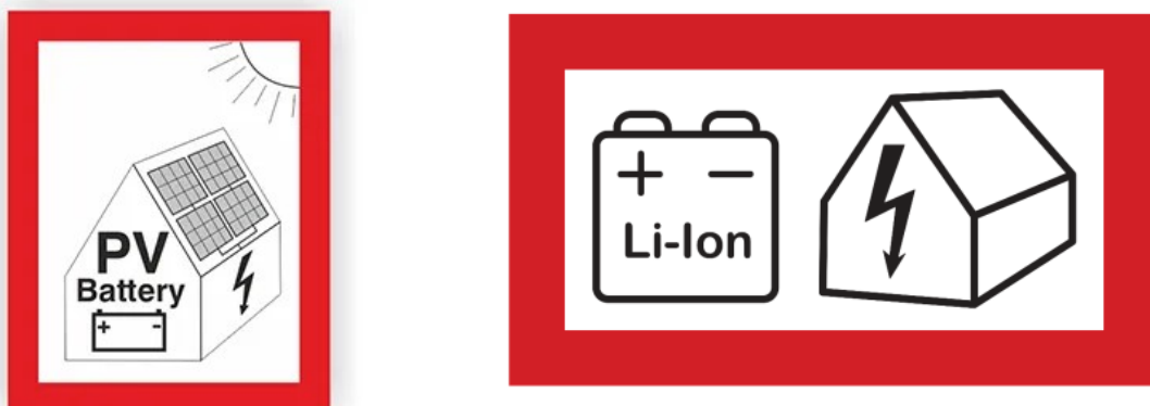
Kuva 1. Esimerkkikuvat aurinkosähkö- ja akkujärjestelmästä ilmoittavasta merkistä.
