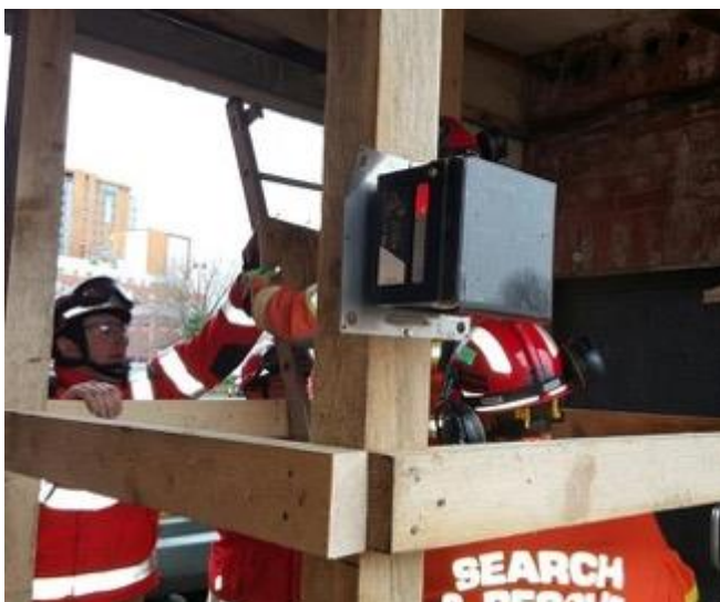
Kuva 45. W.A.S.P liiketunnistin (kuvat FRT:n koulutusmateriaali, PeO)
