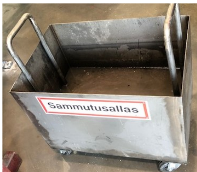
Bild 2. Släckning av små batterier och evakueringsbassäng
