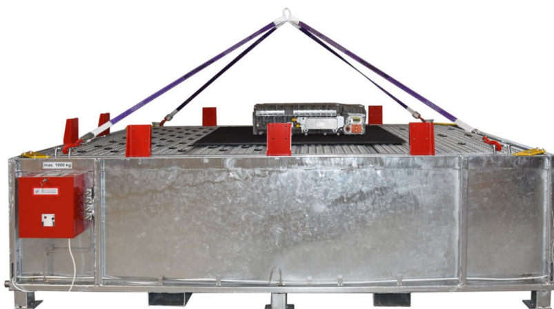
Bild 1. Batterimonteringsbord som gör det möjligt att sänka batteriet manuellt eller automatiskt vid brand.
