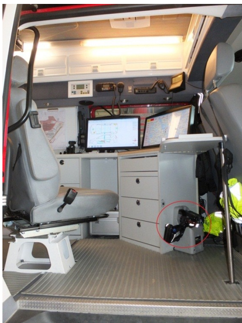
Kuva 8 Lämpökameran sijoittelu (vasemmalla) ja lämpökamerakuva ajoneuvon näytöllä (oikealla)
