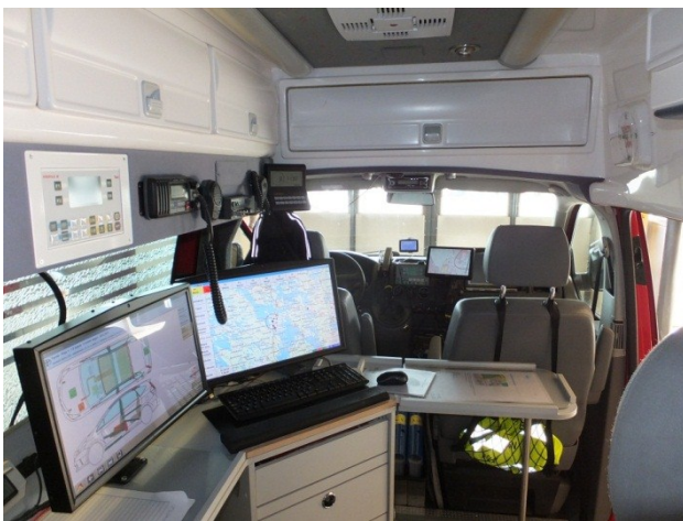
Kuva 7 Näyttöjen sijoittuminen ajoneuvoon
