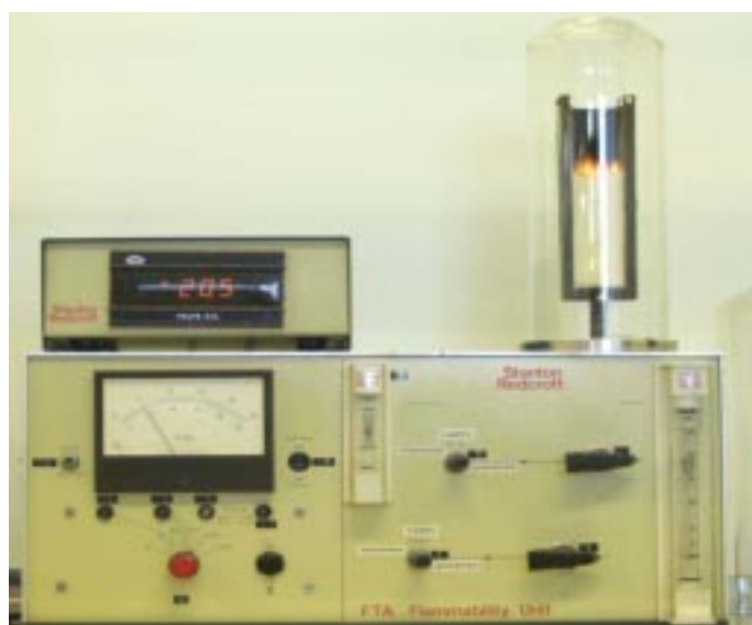
Kuva 2. Happi-indeksin määrittämiseen käytetty laite, FTA Flammability Unit.
